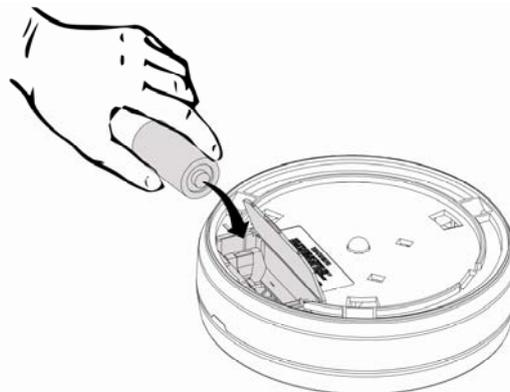
После установки батареи, закройте крышку батарейного отсека и наденьте извещатель на основание.
