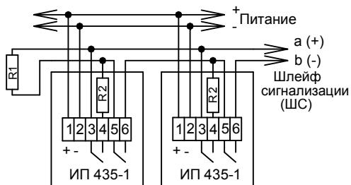
Для ППКОП Сигнал-20П1Smd: R1=4,7кОм, R2=3кОм (изв.Пожар1, Пожар2) или R2=1кОм (изв. Пожар).
