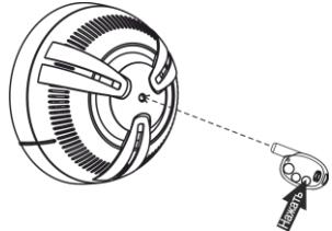
При этом у извещателя на 2 с включается индикация **красного** цвета, затем извещатель переходит в режим поиска радиосети, и **белый** индикатор извещателя мигает с частотой 5 Гц
