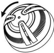
Снять электронный блок с базы извещателя
