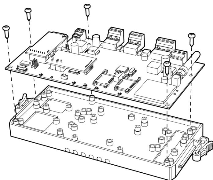
Установите функциональный модуль на держатель с указанной стороны и зафиксируйте его саморезами 3,5x12 с выпуклой головкой. Требуемое количество саморезов определяется функциональным модулем.
