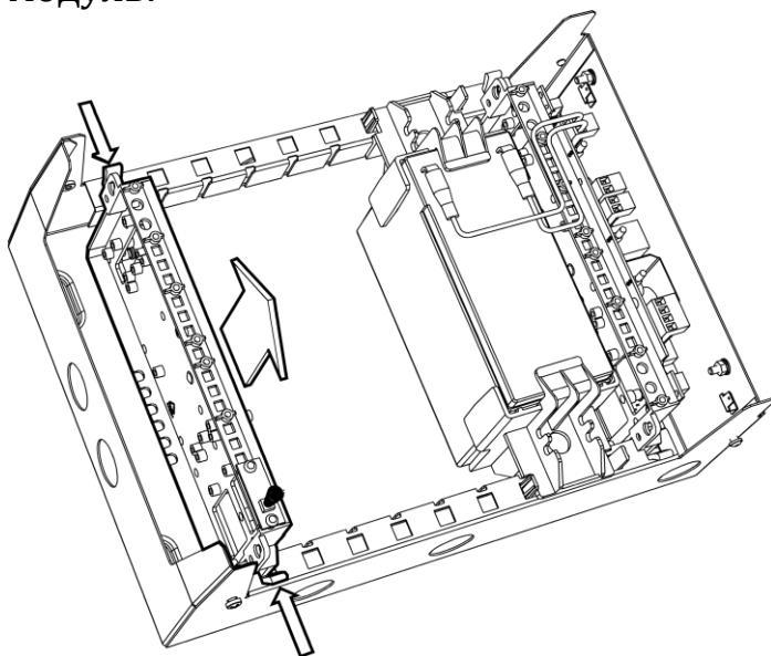
Нажмите на боковые фиксаторы дополнительного держателя и извлеките его, потянув на себя.
