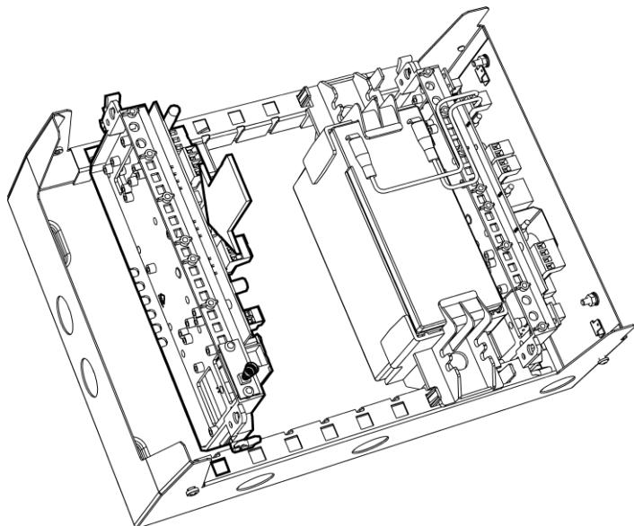
Установите держатель с установленным функциональным модулем по направляющим в основание корпуса.
